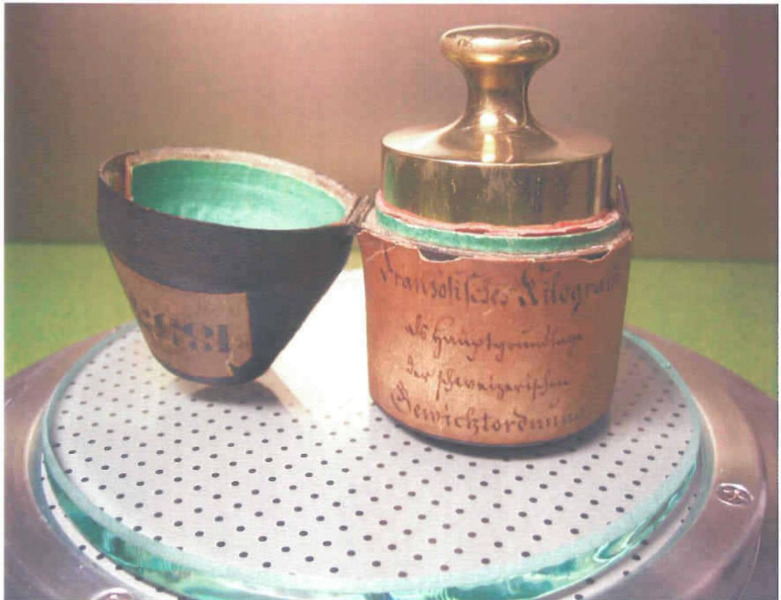
*Bild 2: Komitee Kilogramm in original Lederbehältnis*
