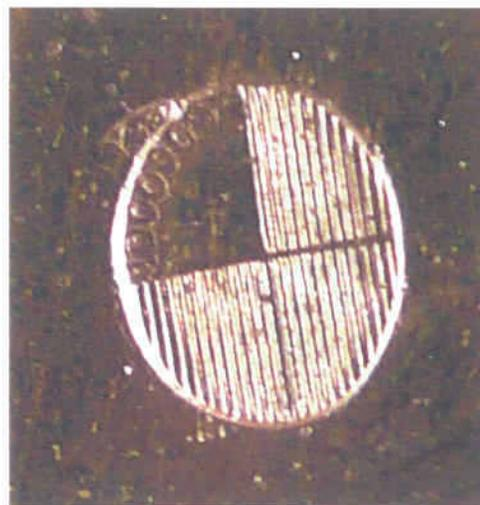
*Bild 3: Prägestempel auf der Unterseite des Gewichtstücks*
